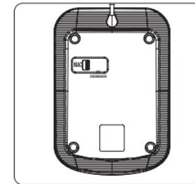
Connecter le cordon USB à l'ordinateur. Ce pavé numérique est un appareil plug and play, il fonctionne automatiquement dès qu'il est branché.
