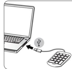
**HINWEIS:** Wenn Sie von einem Nutzungsmodus zum anderen wechseln, entfernen Sie die Tastatur und stecken Sie sie anschließend wieder ein.
