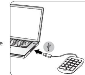
**NOTĂ:** Deconectați și conectați tastatura după ce treceți de pe un mod de utilizare pe celălalt.
