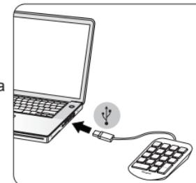
**OPOMBA:** Če preklopite tipkovnico iz enega načina delovanja v drugega, izvlecite kabel tipkovnice in ga znova priključite.
