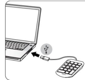
NOTA: Desenchufe y enchufe el teclado tras cambiarlo de un modo de uso a otro.
