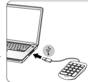
NOTA: desligue e volte a ligar o cabo do teclado após mudar de um modo de utilização para o outro.
