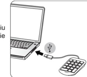
**UWAGA:** Po przełączeniu trybu odłączyć i ponownie podłączyć klawiaturę.
